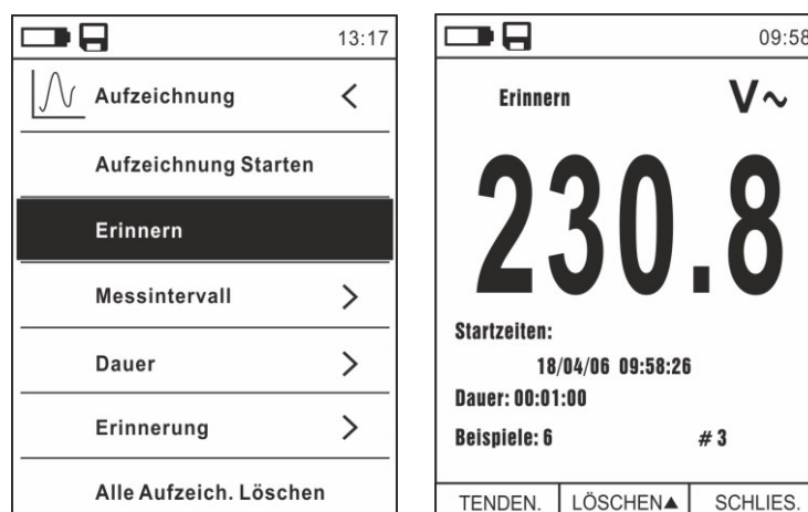
Abb. 34: Data Logger Funktion – Aufruf von aufgezeichneten Daten
