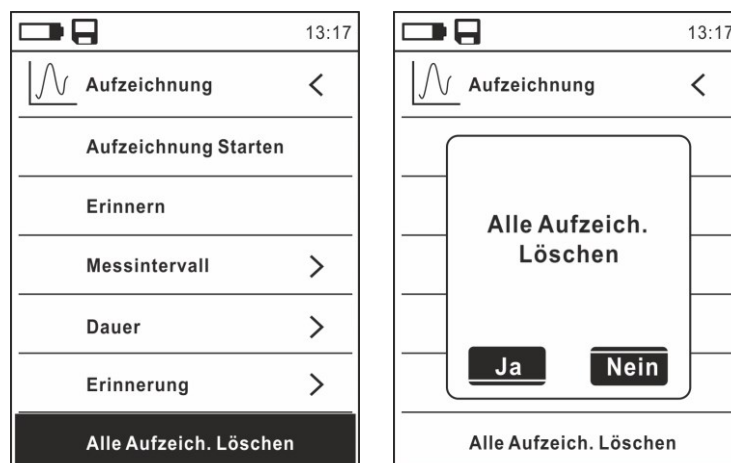
Abb. 38: Data Logger Funktion – Löschung von allen Aufzeichnungen
