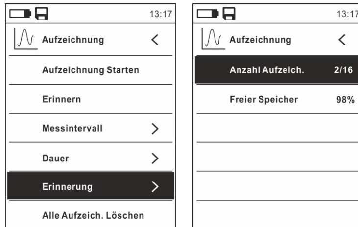
Abb. 37: Data Logger Funktion – Inhalt des Speichers
