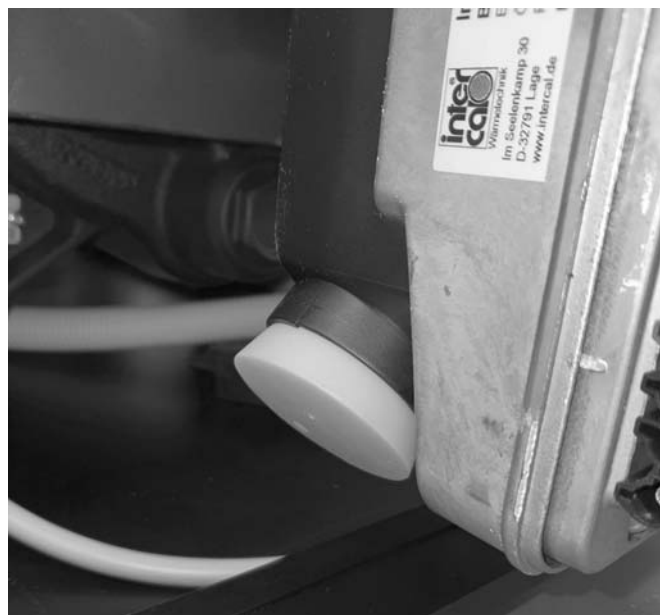
Abb. 8: Zuluftstopfen im Ansaugschalldämpfer
