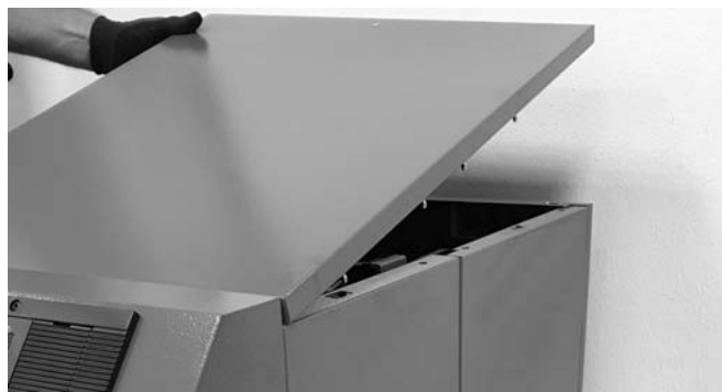
Abb. 4: Demontage der oberen Verkleidung
