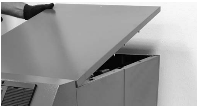
Abb. 79: Demontage der oberen Verkleidung
