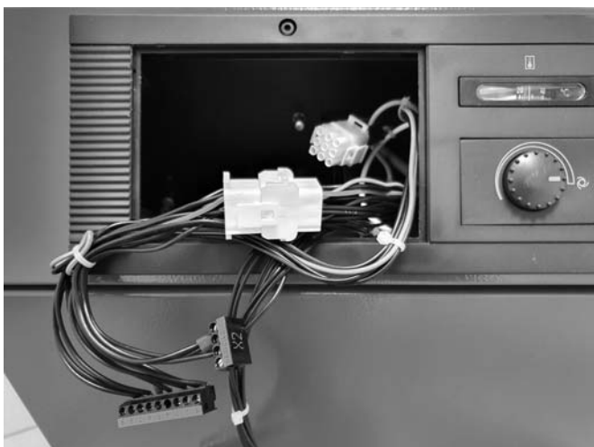
Abb. 33: Anschlussstecker für den Regler.
