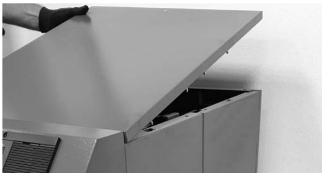
Abb. 26: Demontage des Verkleidungsdeckels
