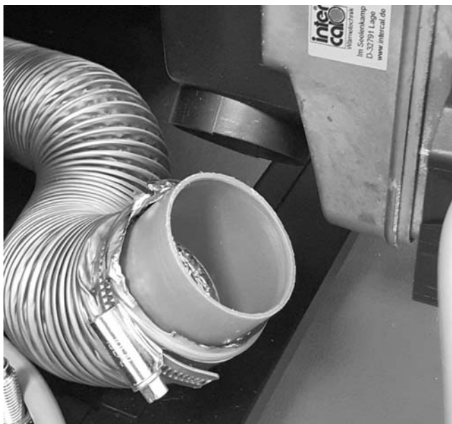
Abb. 13: Zuluftschlauch mit 50 mm Anschluss-Stück
