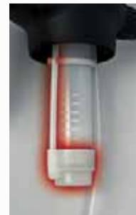
Nylonpumpe mit Überzugsrohr zur Verbesserung der Chemikalien-Beständigkeit.
