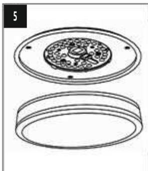
Montieren Sie die Abdeckung wieder am Gehäuse
