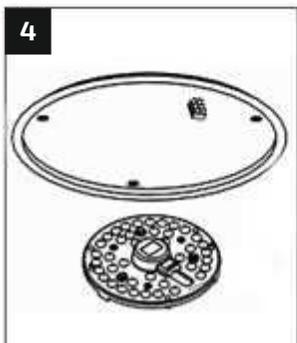
Setzen Sie das QUICKFIX-Modul in die Leuchte. Dieses wird durch Magnete an der Leuchte fixiert
