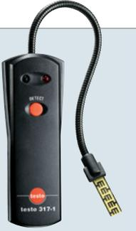
Der Rückstauemelder testo 317-1 detektiert austretende Heizungsabgase zuverlässig. Das handliche Gerät gibt sofort optischen und akustischen Alarm. So ist kein Sichtkontakt zum Messgerät nötig. Der biegsame Fühler ermöglicht den Einsatz auch auf engstem Raum.
