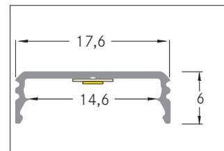
BB-Anbauprofil, flach. Zur optimalen Befestigung des Profiles eignen sich die Halter 53040000. In Verbindung mit den Profilabdeckungen 53489071 53489072 53489073 53489001 53489002 53489003 kann sowohl ein zusätzlicher mechanischer Schutz als auch eine optimale Lichtverteilung erreicht werden. Das zugehörige Endkappen-Set steht unter 53038260 zur Verfügung. Montageart: Anbauprofil, Material: Aluminium, Abmessung Profil: L: 2000 mm x B: 17,6 mm x H: 6 mm .
