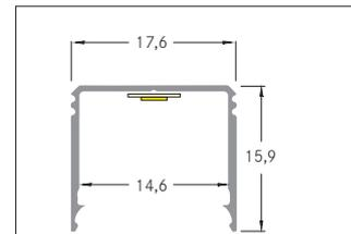
BB-Anbauprofil, hoch. Zur optimalen Befestigung des Profiles eignen sich die Halter 53040000. In Verbindung mit den Profilabdeckungen 53489071 53489072 53489073 53489001 53489002 53489003 kann sowohl ein zusätzlicher mechanischer Schutz als auch eine optimale Lichtverteilung erreicht werden. Das zugehörige Endkappen-Set steht unter 53039260 zur Verfügung. Montageart: Anbauprofil, Material: Aluminium, Abmessung Profil: L: 2000 mm x B: 17,6 mm x H: 15,9 mm .
