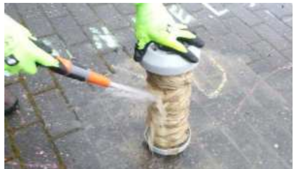
Spülen der Membranfasernbündel
