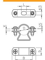
Мав А 58,00 mm Maß B 42,00 mm Maß b 16,00 mm Maß D 29,00 mm Maß D 29,00 mm Maß L 10,00 mm Мав х 11,00 mm Abstand zur Wand  $\checkmark$ Anzahl der Kabel/Rohre 1,00 Ausführung geschlossen Befestigungsart Schraubloch Geeignet im Brandschutzbe- $\checkmark$ reich Größe M25 Halogenfrei  $\checkmark$ Kunststoffummantelt Lochgröße 6,5 x 10 mm Materialstärke 1,50 mm Schraube M5 x 16 24,00 - 29,00 mm Spannbereich D UV-beständig  $\checkmark$
