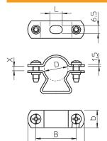
Мав А 70,00 mm Maß B 54,00 mm Maß b 16,00 mm Maß D 38,00 mm Maß D 38,00 mm Maß L 10,00 mm Мав х 11,50 mm  $\checkmark$ Abstand zur Wand Anzahl der Kabel/Rohre 1,00 Ausführung geschlossen Befestigungsart Schraubloch Geeignet im Brandschutzbe- $\checkmark$ reich Größe M32 Halogenfrei  $\checkmark$ Kunststoffummantelt Lochgröße 6,5 x 10 mm Materialstärke 1,50 mm Schraube M5 x 18 30,00 - 38,00 mm Spannbereich D UV-beständig  $\checkmark$
