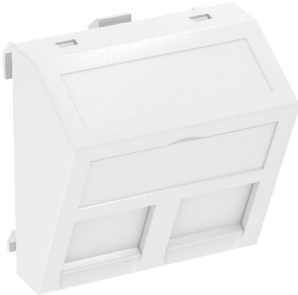
Datentechnikträger mit schrägem Auslass und Verschlusschieber zur Aufnahme von zwei Datentechnik-Anschlussmodulen mit RJ45-Buchse. Die Rastbefestigung eignet sich für den waagerechten und senkrechten Einbau in die Systemumgebung. Typ RM hat eine spezielle Modulaufnahme und ist für eine indirekte Befestigung der Daten-Anschlussmodule in der Montageöffnung ausgelegt.
