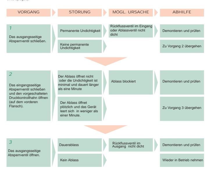
MERKE: Während des Normalbetriebs darf das Gerät keine permanenten Undichtigkeiten aufweisen. Andernfalls ist es zu demontieren und zu prüfen.
