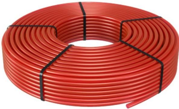
Dieses Polyethylen-Rohr mit erhöhter Temperatur besteht aus 5 Schichten. Die erste Schicht bzw. die Grundschrift besteht aus PE-RT Typ 1. Die zweite Schicht ist eine Klebeschicht zur Befestigung der dritten Schicht, der EVOH-Schicht. Diese Schicht garantiert, dass das Rohr die Sauerstoffdiffusion stoppt. Die vierte Schicht ist ein Kleber und die fünfte PE-RT Typ 1. Der Schlauch ist undurchlässig für die Sauerstoffdiffusion nach DIN 4726.
