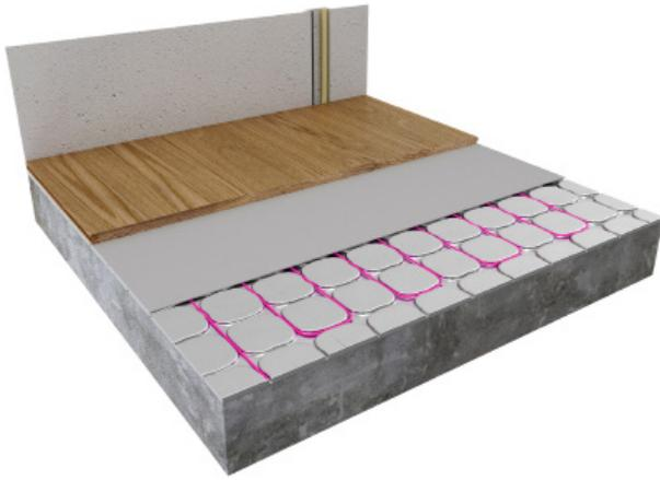
Mit einer Aufbauhöhe von nur 12 mm ist Heatboard das **dünnste Trockenbausystem seiner Art. Vorgeformte Aluminiumbleche werden nach einem neuen, patentierten Verfahren mit High-Density EPS-Platten verleimt. Dadurch hat das Heatboard-System über den gesamten Boden Kontakt und es bietet, im Gegensatz zu vergleichbaren Produkten, auch in den Kurven eine maximale Wärmeübertragung.**
