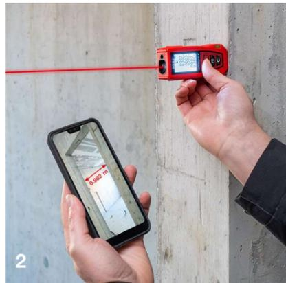
1) Besonders hilfreich ist die integrierte Libelle im METRON 30 BT. Diese sorgt dafür, dass das Gerät bei waagrechten Messungen korrekt ausgerichtet wird. Der Vorteil: präzisere Messergebnisse.
