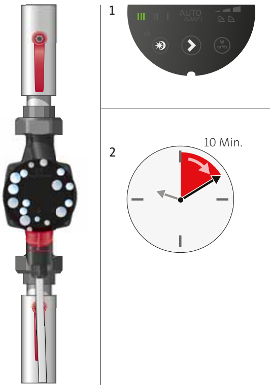
Abb. 13 Entlüften der Pumpe
