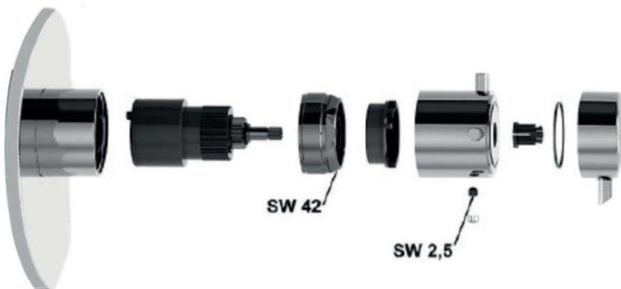
Bei der Montage des Anschlagrings unbedingt die Position (5a, S. 9) beachten.
