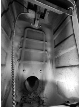
Fig. 76 - Mit einer Rohrreinigungsbürste reinigen
