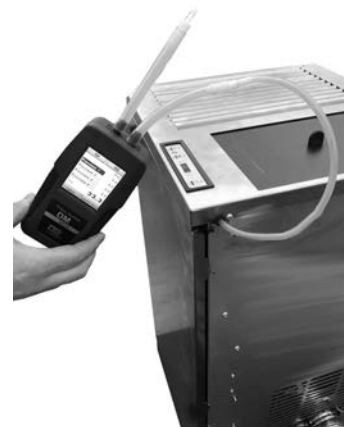
Fig. 70 - Anschluss des Digitaldruckwächters
