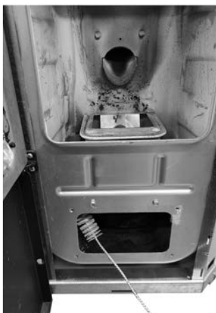
Fig. 74 - Mit einer Rohrreinigungsbürste reinigen
