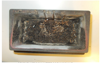
BEISPIEL VERSCHMUTZTE BRENNSCHALE
