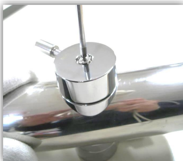
Fig. 2 – Svitare la vite con una chiave a brugola 2.5 mm Unscrew the screw by a 2.5 mm hex wrench Die Schraube mit einem 2,5 mm Inbusschlüssel lösen Dévisser la vis avec une clé hexagonale de 2,5 mm Desatornillar el tornillo con una llave hexagonal de 2,5 mm
