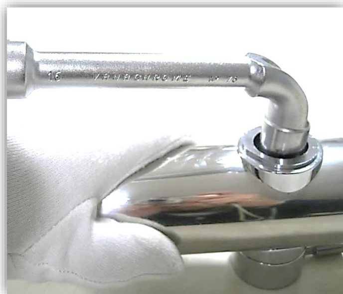
Fig. 6 – Avvitare a fondo con una chiave fissa da 16 mm Screw carefully by a 16 mm normal wrench Mit einem 16 mm normalen Schraubenschlüssel vorsichtig schrauben Visser soigneusement avec une clé normale de 16 mm Atornillar cuidadosamente con una llave normal de 16 mm
