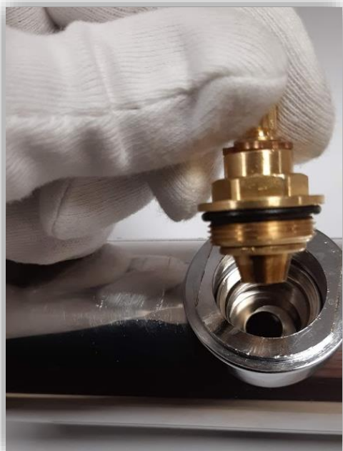
Fig. 5 – Inserire nuovo vitone verificando la corrispondenza acqua calda / acqua fredda Insert the new headwork verifying the correspondence cold/warm water Den neuen Oberteil einstecken und auf der Übereinstimmung von Kalt-/Warmwasser aufpassen Insérer la nouvelle tête en vérifiant la correspondance eau froide/eau chaude Insertar la nueva montura verificando la correspondencia agua fría/agua caliente
