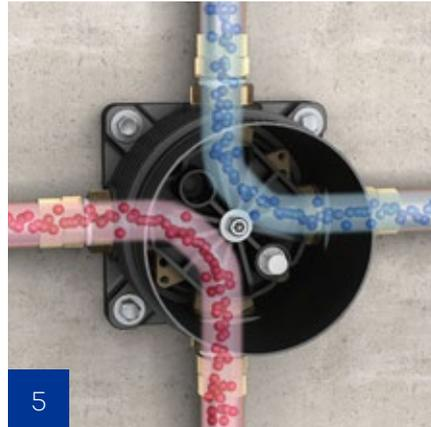
5 Spülen nach DIN 1988 mit integriertem Prüf- und Spülblock
