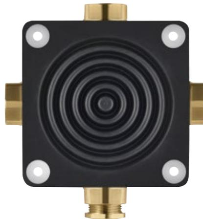
Alle wasserführenden Komponenten haben keinen direkten Kontakt zur Wand. Sie werden komplett von dem Elastomere-Mantel umschlossen, der die Fließgeräusche absorbiert, bevor sie sich auf die Wand übertragen.
