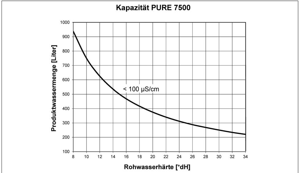
Abb. 7: Füllwassermenge PURE 7500
