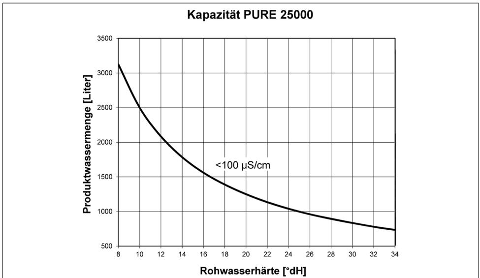
Abb. 8: Füllwassermenge PURE 25000
