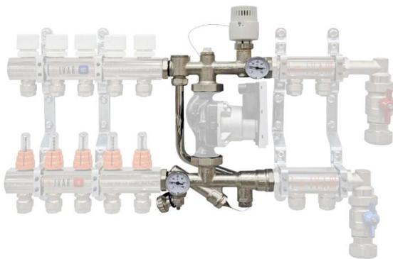
TECHNOMIX ist eine Misch- und Umwälzgruppe für Flächensysteme. Die Regelung der Vorlauftemperatur erfolgt mithilfe eines Zwei-Wege-Ventils, das den Wärmeträgerzustrom zum Mischer regelt („Einspritzschaltung“). Die Gruppe ist mit Festwertregelung mittels Thermostatkopf erhältlich.
