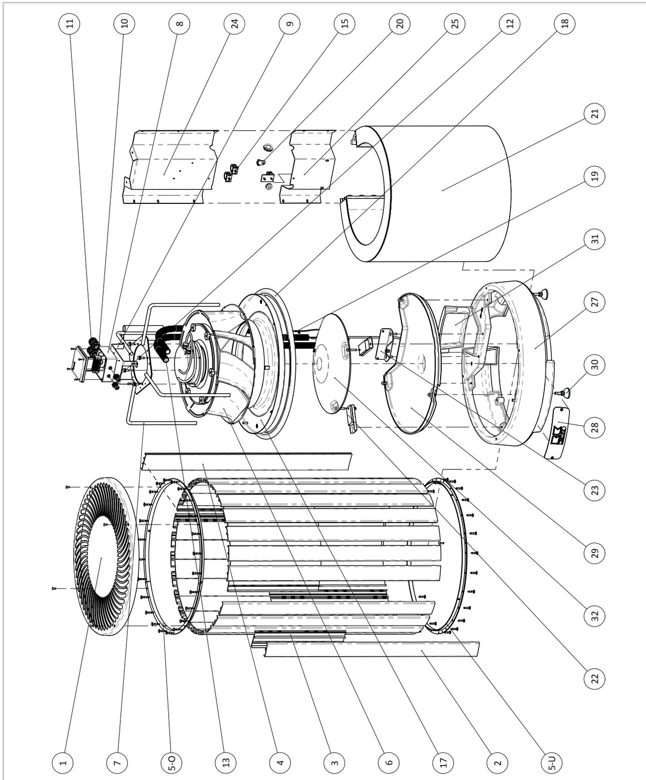
Abb. 1: Explosionszeichnung Außenmodul HTS 80/90/110/130/200/260
