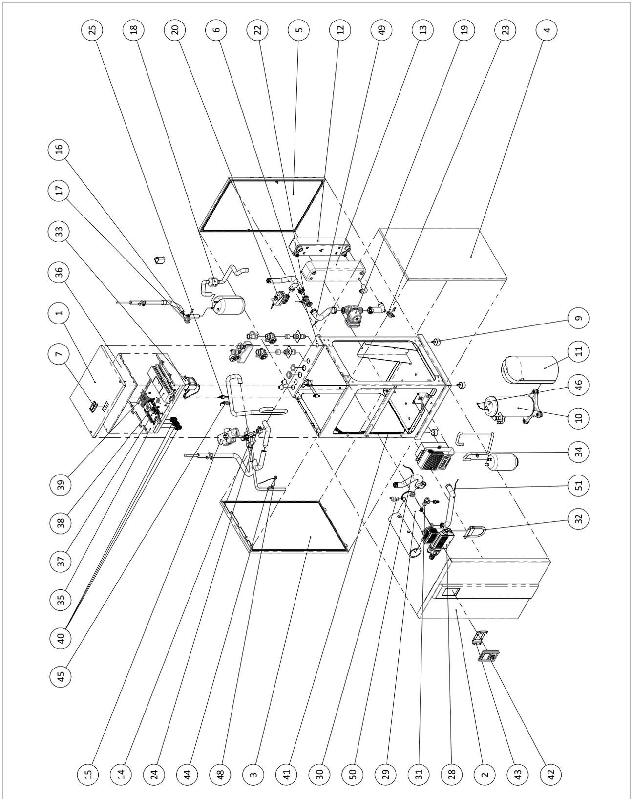
Abb. 2: Explosionszeichnung Innenmodul HTS 80/90/110/130/200/260
