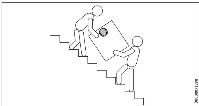
Wenn Sie das Gerät beim Transport ankippen, darf dies nur kurzzeitig über eine der Längsseiten geschehen. Je länger das Gerät gekippt wird, desto mehr verteilt sich das Kältemittelöl im System.
