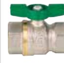
IG x IG - Totraumfrei • Mit Aluminium Flügelgriff • Schutz vor Legionellenbildung • Kein Totraum zwischen Kugel und Körper
