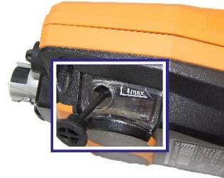
2 Kondensat in einen Ausguss auslaufen lassen
