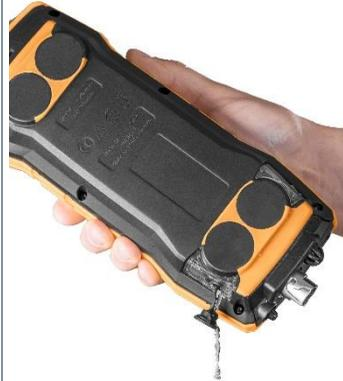
3 - Resttropfen am Kondensatauslass mit einem Tuch abtupfen und Kondensatauslass schließen.
