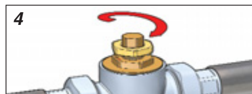
Blockieren der Regelvorrichtung mit Nutmutter
