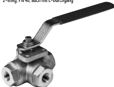
3-Wege-Kugelhahn DIN 2999, T-Durchgang reduziert 2-teilig; PN 40, auch mit L-Durchgang
