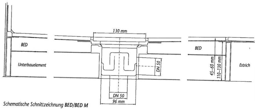
Schematische Schnittzeichnung BED/BED M
