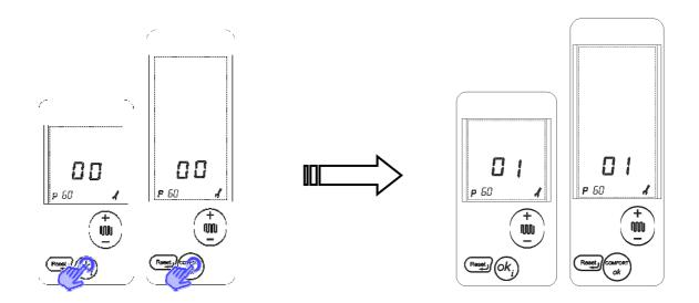
An diesem Punkt angelangt, die Änderung des Wertes des Parameters durch Drücken der Taste "ok" bestätigen.
