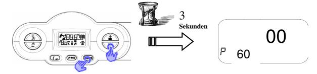
Durch Drücken der Taste "OK", wird den Vorsatz bestätigt, den Parameter zu ändern und das Symbol des Service-Schlüssels weist darauf hin, dass seine Änderung über die Tasten "+/- Heizung" möglich ist:
