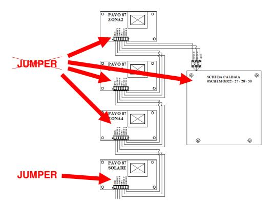
Den Jumper nur an der letzten Zusatzplatine der Kaskade anordnen.
