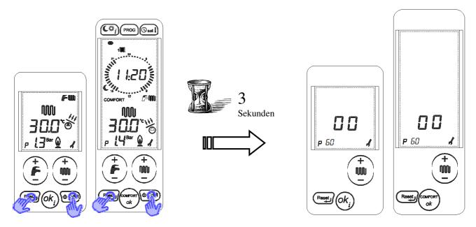
Durch Drücken der Taste "ok" wird der Vorgang um den Parameter zu ändern bestätigt, das Symbol des Serviceschlüssels weist darauf hin, dass eine Änderung über die Tasten "+/- Heizung" möglich ist:
