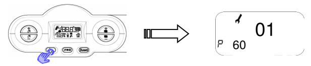
An diesem Punkt angelangt, die Änderung des Wertes des Parameters durch Drücken der Taste "*OK*" bestätigen.
