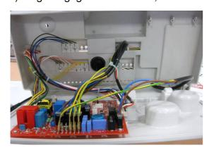
e) die Solarplatine wie abgebildet an der vorgesehenen Montagestelle anordnen und mit den vier mitgelieferten kurzen Schrauben befestigen;
