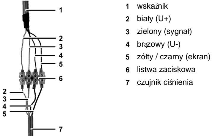
Ilustracja 3: Połączenie przewodów
