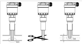
Zuletzt kontrollieren Sie erneut die Einstecktiefe und pressen anschliessend das Bauteil an das Rohr.
