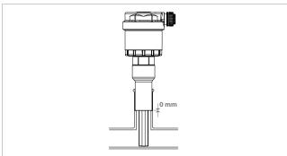
Vergewissern Sie sich, dass die untere Plastikfahne nicht in Kontakt mit der Rohrunterseite kommt. Falls nötig, kürzen Sie die Plastikfahne an den Markierungen. Das Ende der Fahne soll mittig im Rohr sitzen.
