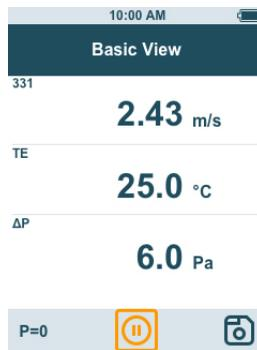
En fonction de la sonde connectée, des paramètres tels que la visibilité de différentes valeurs ou les unités peuvent être réglés pour la mesure.
