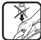
Arbeiten Sie mit geringem und gleichmäßigem Anpressdruck, sonst verschlechtert sich die Arbeitsleistung und das Einsatzwerkzeug kann blockieren.
