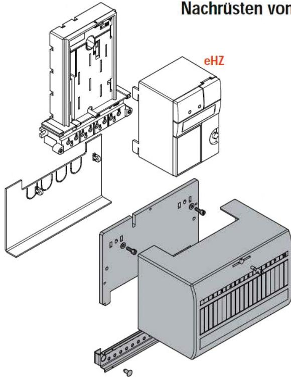
Durch den modularen Aufbau des Systems ist es möglich, bereits vorhandene eHZ-Adapter mit dem eHZ-Zusatzraum auszubauen.
