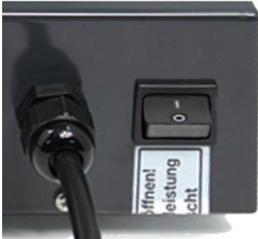
Abb. 21: Einschalten der Steuerung
