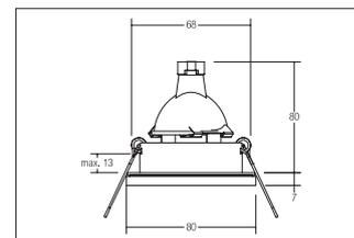
Einbaudownlight, IP65, chrom, rund. Ausgeführt in kompakter Bauform für werkzeuglose Schnellmontage zum Deckeneinbau. Fassung: GX5,3, Montageart: Einbaumontage, Montageort: Deckenmontage, Material: Guss / Glas, Schutzart: nach DIN EN 60529: IP65\*, Schutzklasse: (EN 61140) III, Spannung: 12V, Leistung: max. 50W, Anzahl der Leuchtmittel / Fassungen: 1.0 Stk, Verstellbarkeit: nicht verstellbar, ohne Betriebsgerät, Art der Dimmung: sonstige.
