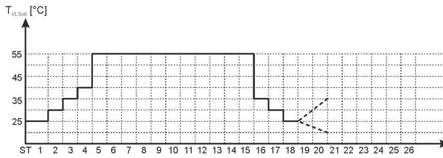
Abb. 71: Zeitlicher Ablauf - Belegreifheizen
