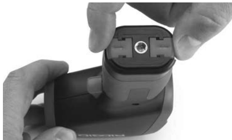
Rysunek 4 – Wyjmowanie komory baterii
