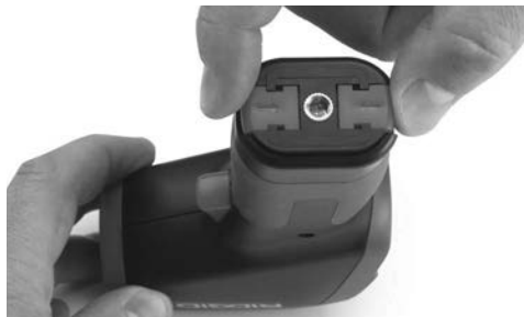
Slika 4 – Odstranjevanje prostora za baterije
