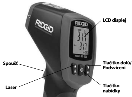
Obrázek 9 – Displej/Tlačítka micro IR-200
