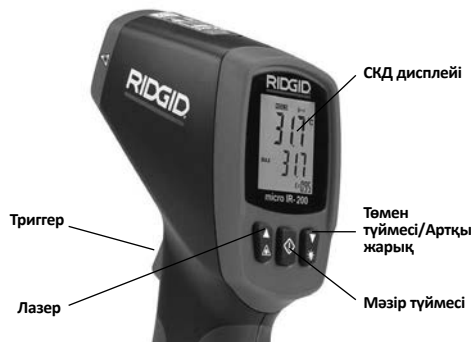
9-сурет – micro IR-200 дисплейі/түймелері
