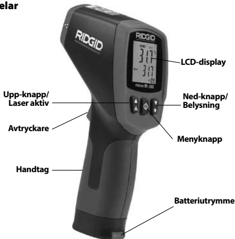
Figur 2 – Knappar på micro IR-200
