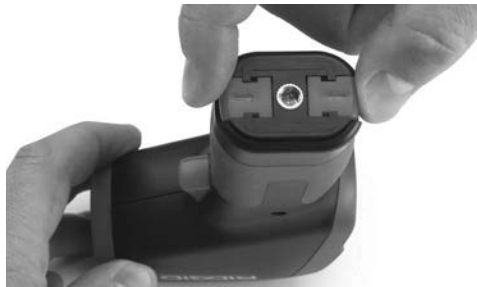
Figura 4 – Scoaterea compartimentului bateriei
