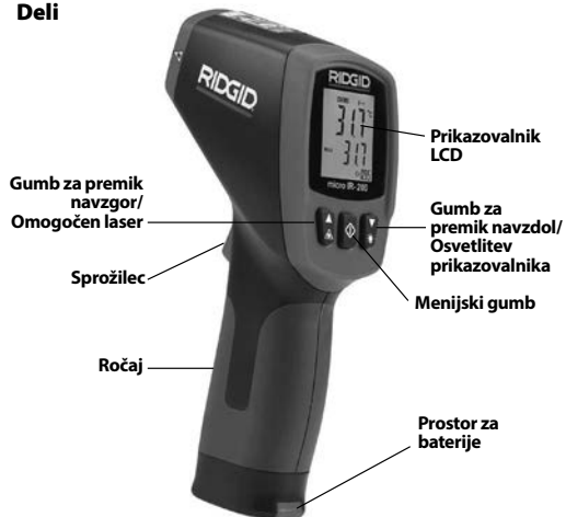
Slika 2 – Deli instrumenta micro IR-200
