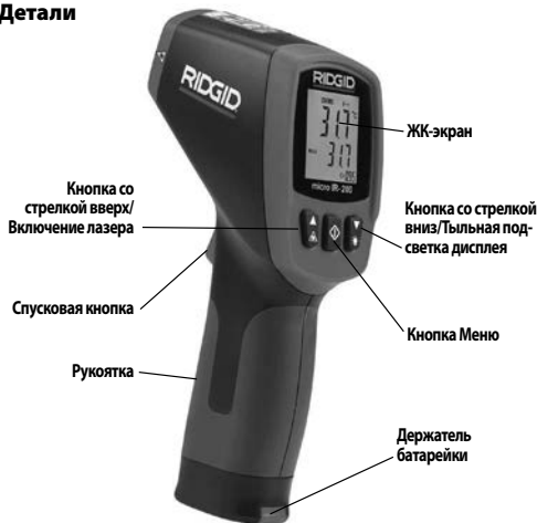
Рис. 2 – Детали прибора micro IR-200
