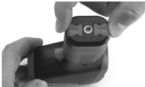
Рис. 4 – Извлечение держателя батарейки
