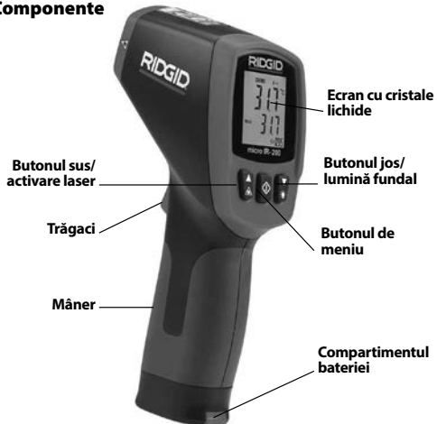
Figura 2 – Componentele micro IR-200
