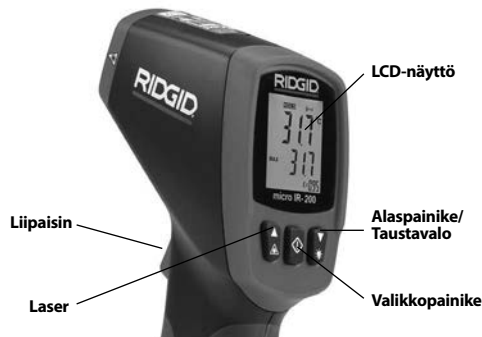
Kuva 9 – micro IR-200: N näyttö/painikkeet
