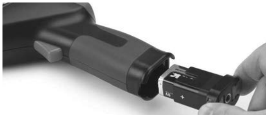
Rysunek 5 – Uchwyt baterii i oznaczenie biegunowości
