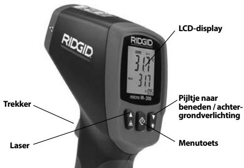
Figuur 8 – Display/Toetsen van de micro IR-200
