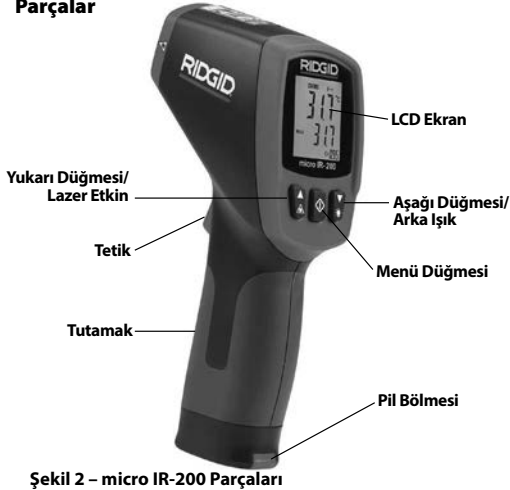
Şekil 2 – micro IR-200 Parçaları
