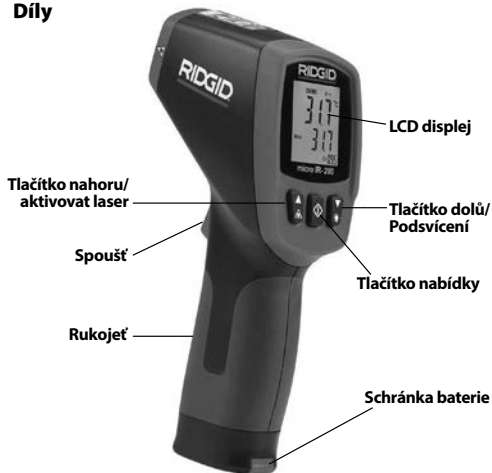
Obrázek 2 - Díly micro IR-200
