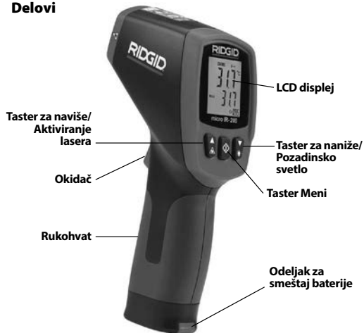
Slika 2 – Delovi uređaja micro IR-200
