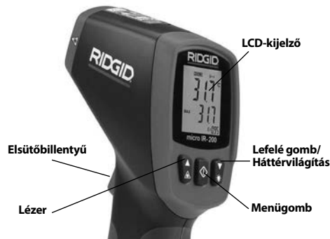
9. ábra – A micro IR-200 kijelzője/gombjai
